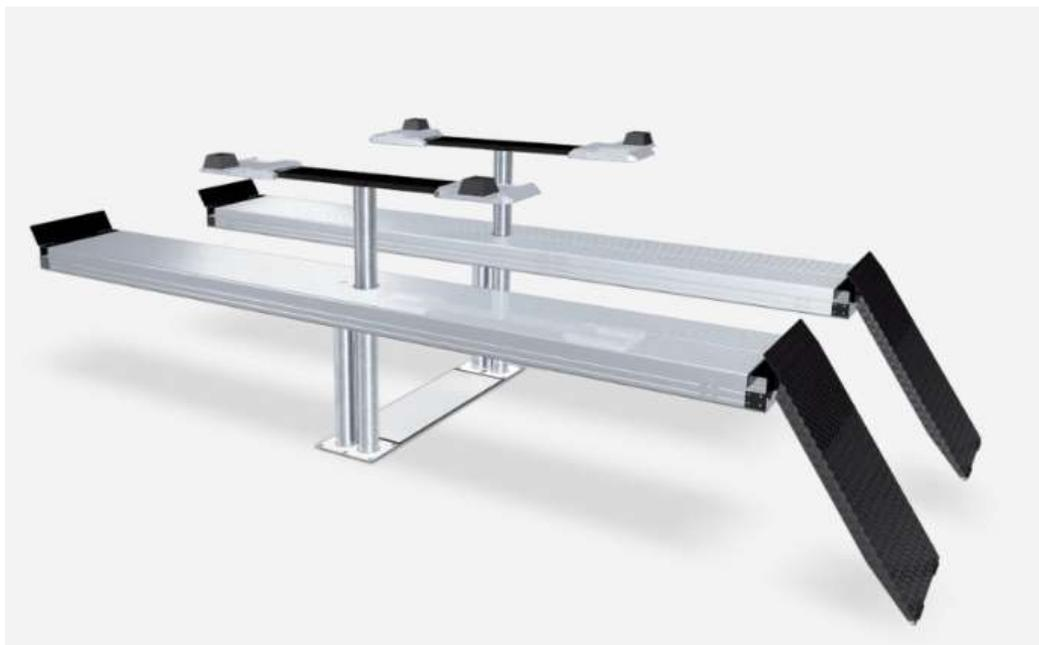
5,0 т, с гальванизированным алюминием (листы с алюминиевыми квадратами) аппаратами и дополнительными поддерживающими платформами (MP), с перемещаемыми продольно и поперечно алюминиевыми опорами, 4 галогеновые фонаря внутри платформ, функции переключателя включения и выключения для подъема и опускания, в комплект поставки входят 4 резиновые опоры 70 мм, 4 ограничителя для въезда, 1 распорка для возможного сочленения платформ и 4 въездных клина длиной 400 мм
